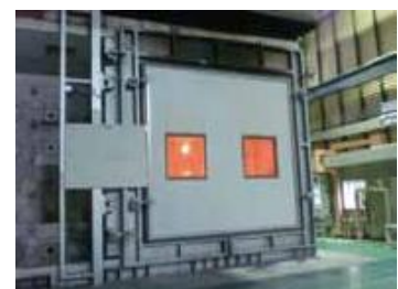
耐火性能試験の様子
