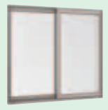
G-3EF型用/防火戸 引き違い窓(アルミ形材) (Low-E複層ガラス入り 網入り型6.8mm+空気層12mm+Low-E3mm) サイズ:W780×H570mm ※網戸は別売り
