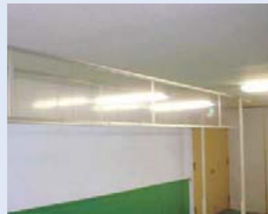
柱の変位を0に戻すとダンスモークのたわみは、ほぼ回復します。
