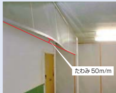
柱の変位100m/m時におけるダンスモークのたわみは50m/mとなりました。
